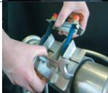
Der Rest funktioniert per Hebelwirkung: Man drückt die Unterkante der Schelle und den Maulschlüssel mit einer Hand zusammen und kann nun mit der anderen Hand ganz bequem die bewegliche Haltebrücke auf der Oberkante der Edelstahlschelle platzieren. Muttern festziehen, fertig!
