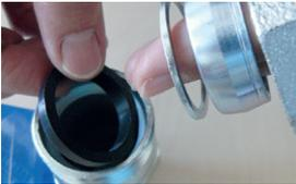
**Bild 4:** Vorlegering auflegen, Klemmring auflegen, Konusmutter aufschrauben
